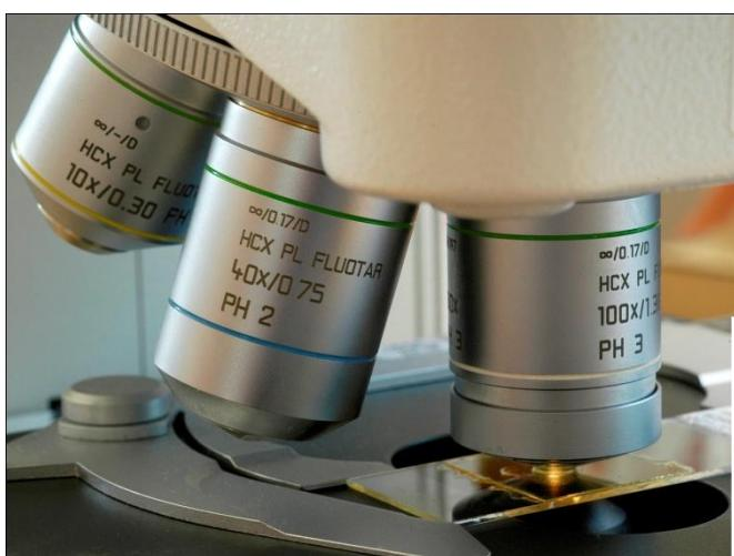
Figur 1. Kiselalgsanalys görs i ljusmikroskop i minst 1000 gånger förstörning med oljeimmersionsobjektiv. Mikroskopet ska helst vara utrustat med interferenskontrast, vilket gör att man kan se mycket små former tydligare än med andra tekniker, © Medins Biologi AB
