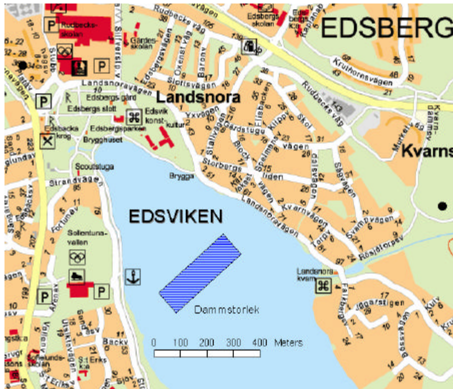
Figur 7 Skisserat totalt ytbehov (10 ha) för dagvattenanläggningarna.
