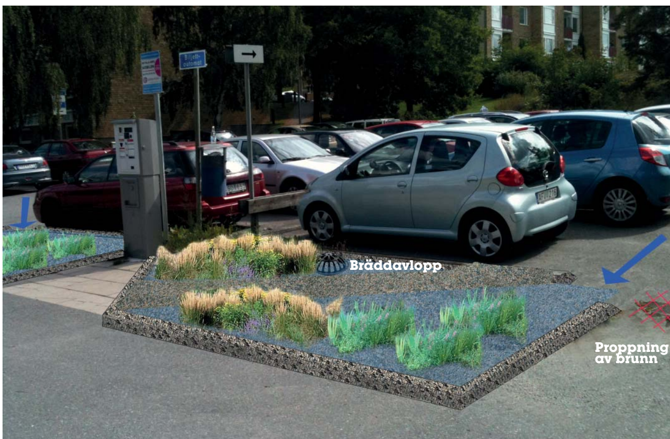
EFTER: NEDSÄNKT REGNGÅRD Uppbrytning av asfaltsyta och släpp i kantsten med en gruspassage.
