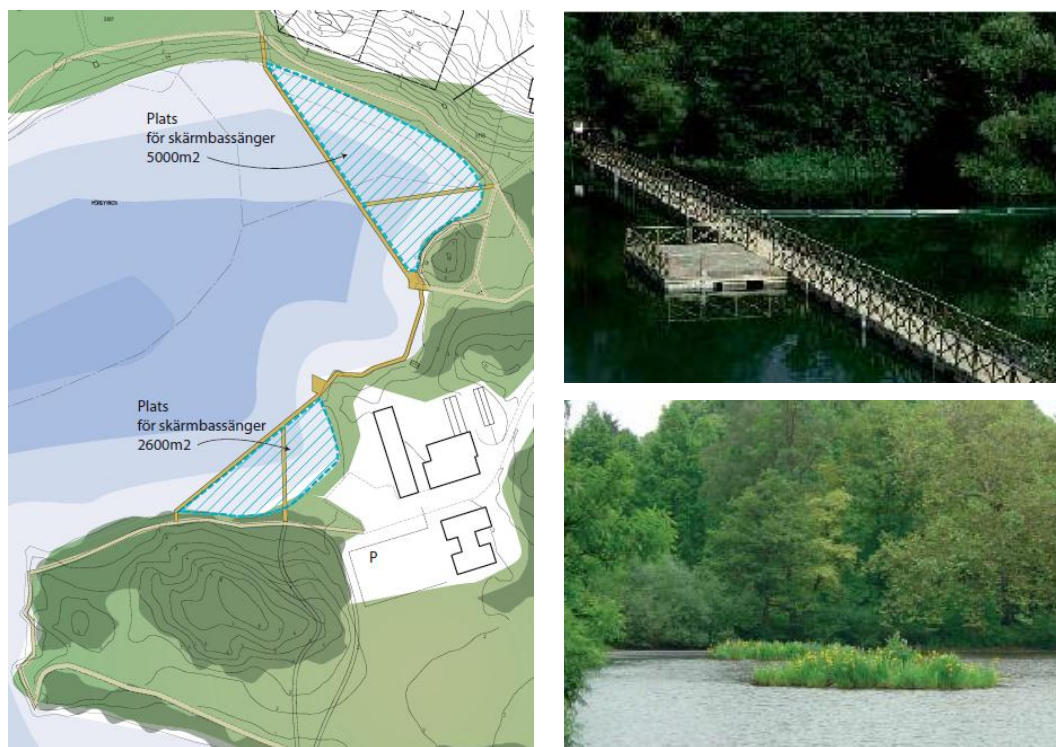
Figur 8. Förslag på lokalisering av trädäck med skärmbassänger. Vid behov av ökad reningseffekt kan bassängerna kompletteras med flytande växtbäddar (nedan t.h.)
